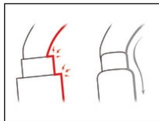
Le design intérieur fluide des mousquetons Am'D limite le risque de point stable et facilite la rotation du mousqueton.
