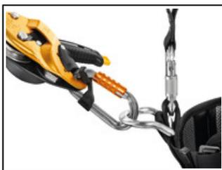
Le mousqueton Am'D est doté d'une forme en D, asymétrique, idéale pour la connexion des appareils de type descendeurs ou longes de maintien. L'utilisation de la barrette CAPTIV favorise la sollicitation du mousqueton selon son grand axe, limite le risque de retournement et le solidarise à l'appareil ou à la longe.
